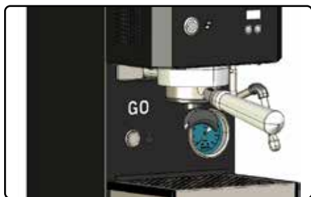
Abb. 7 Filterträger installiert, Griff nach vorn gerichtet
