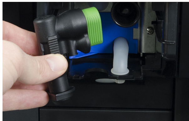
Abb. 39: Milchschaumer mit Dampfdüse entnehmen
